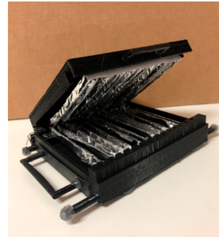
De PlastiShark: prototype van een plasticversnipperaar voor huishoudelijk gebruik, door Isabel van Bokhoven en Femke van de Vijver
